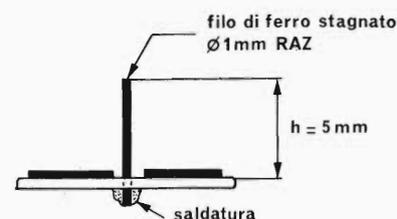
Fig. 7 - Un gambo di rimessa a zero.
