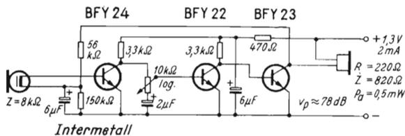
Figura 5 - Semplice ma efficientissimo otophono Intermetall. Con tre stadi eroga un guadagno di 78 dB. Il rumore di fondo è ridotto.
