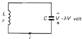
Fig. 7.7 - Il circuito oscillante, al termine del primo metà ciclo di oscillazione.
