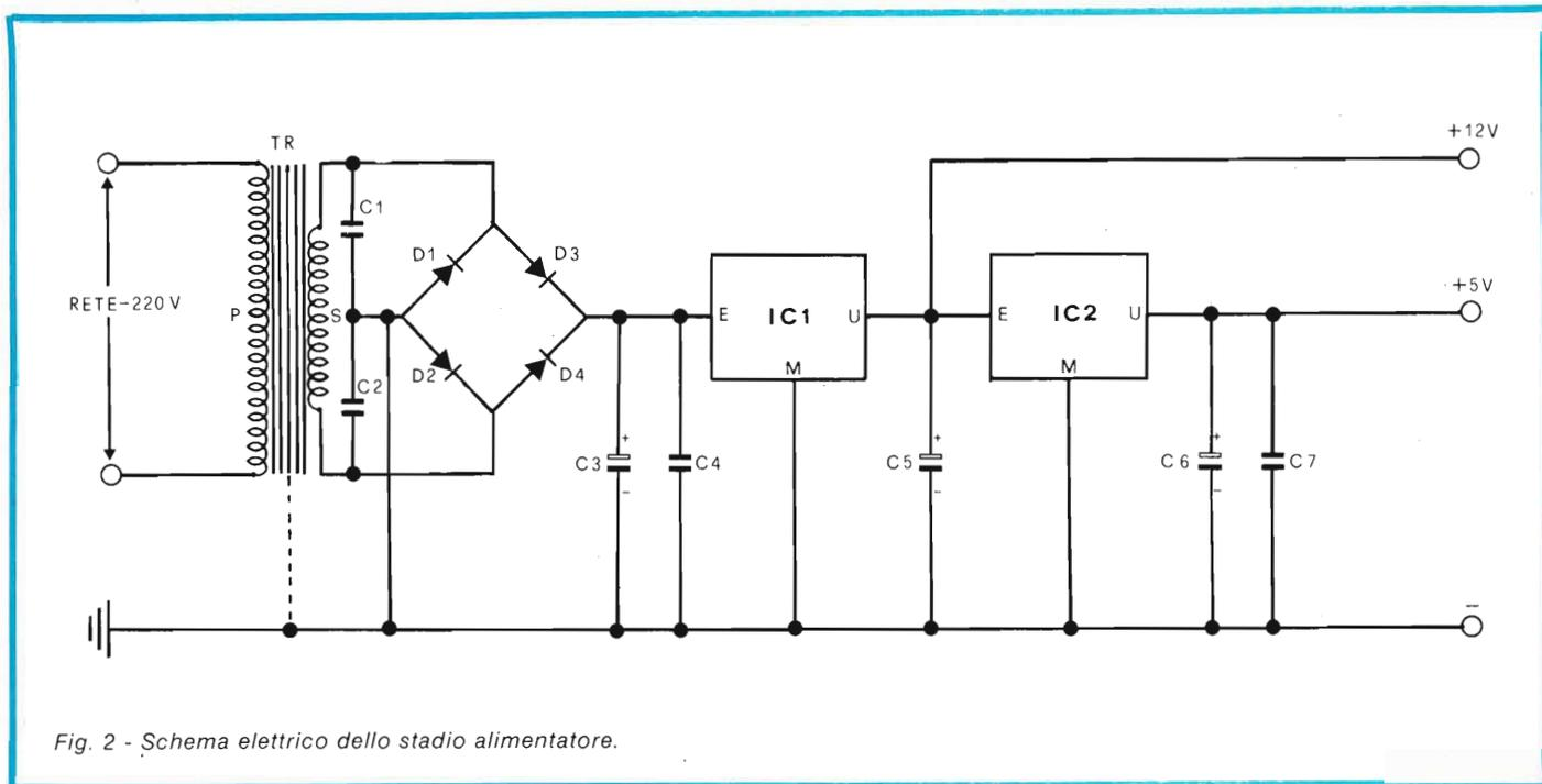
Fig. 2 - Schema elettrico dello stadio alimentatore.
