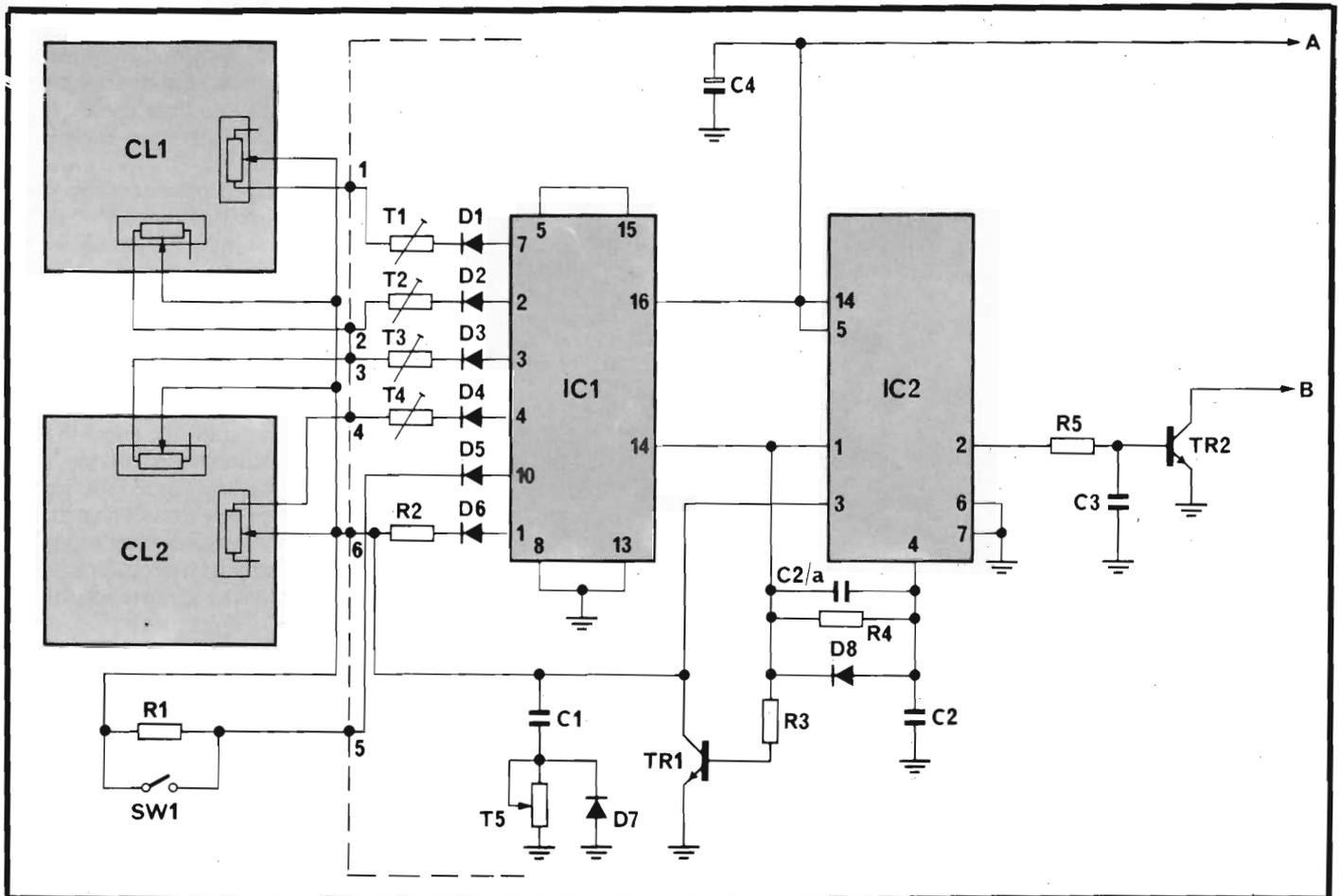
Fig. 2. - Circuito del modulatore impulsivo ad onde quadre. Il complesso dei treni d'onde ha la stessa ampiezza, ma la "spaziatura" o "Duty ratio" dipende dalla posizione delle cloche. Le funzioni controllabili in tutto sono cinque.
