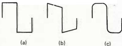
Fig. 7.4 - Distorsioni nella forma d'onda rettangolare introdotte da un amplificatore con banda passante limitata.
