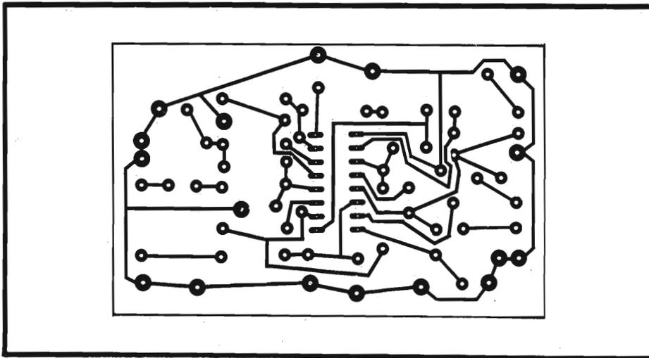
Fig. 5 - Basetta a circuito stampato in scala 1 : 1.
