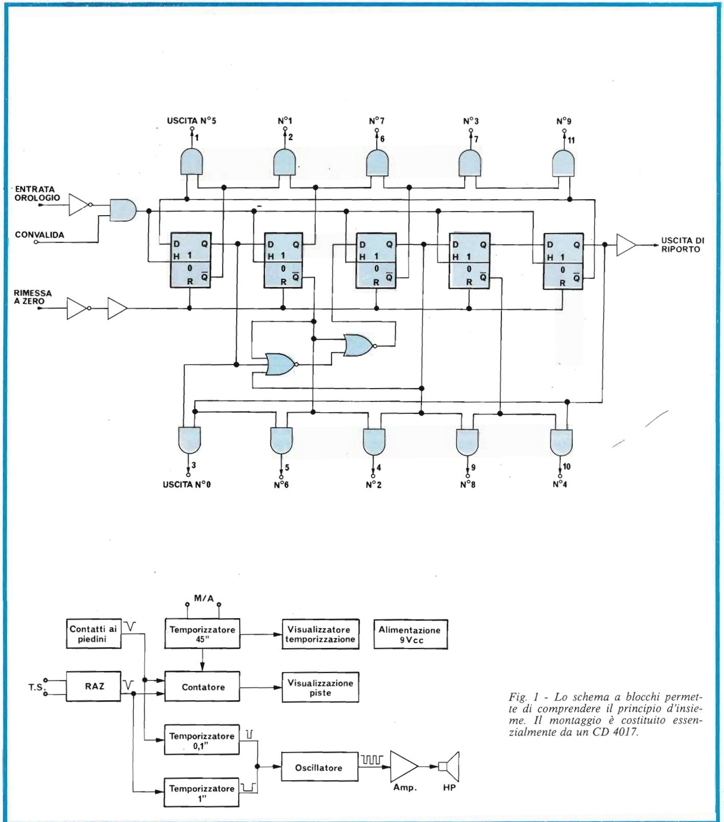
Fig. 1 - Lo schema a blocchi permette di comprendere il principio d'insieme. Il montaggio è costituito essenzialmente da un CD 4017.
