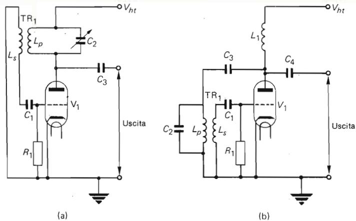
Fig. 7.14 - Oscillatori con accordo di anodo: a) con alimentazione in serie, b) con alimentazione in parallelo.
