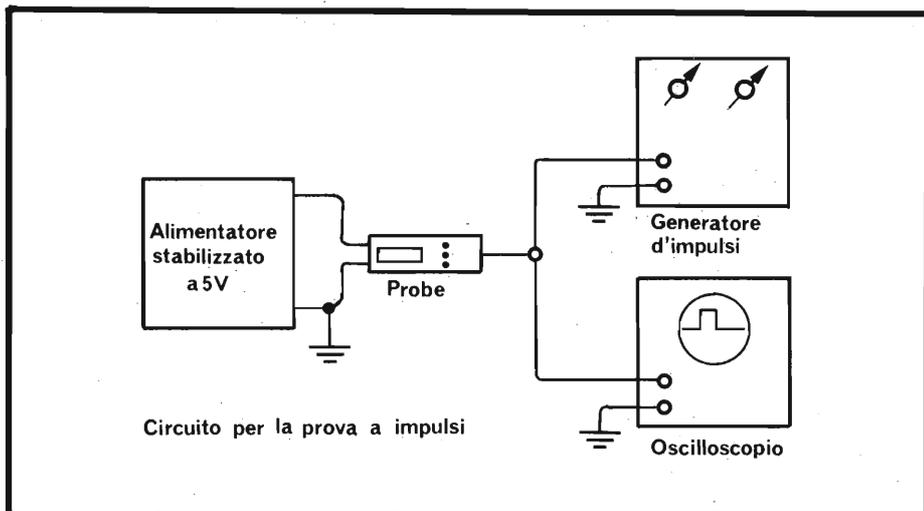
Fig. 3 - Sistema di prova con gli impulsi.
