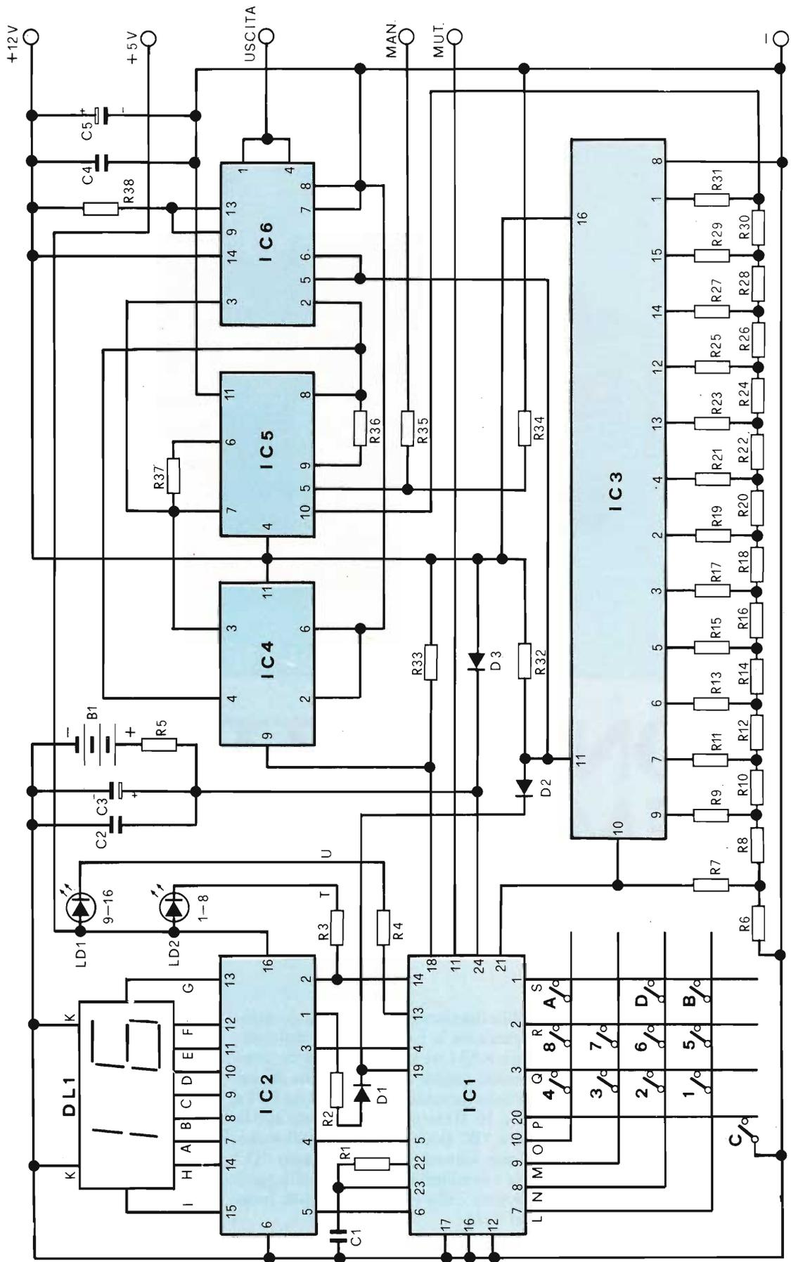
Fig. 1 - Circuito elettrico completo della sintonia elettronica a 16 canali.
