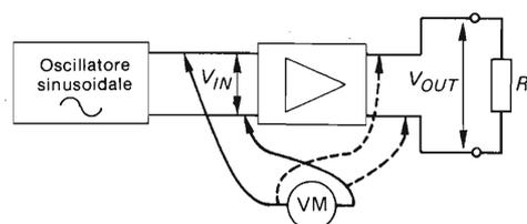
Fig. 7.2 - Misura del guadagno in tensione di un amplificatore.
