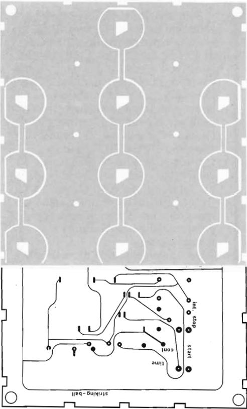
Fig. 4 - Si è reso necessaria la realizzazione di un circuito stampato del tipo a doppia faccia. La piastra rispecchia la faccia superiore in scala 1 : 2.
