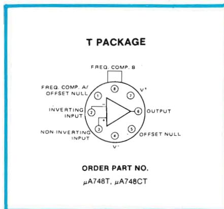
Fig. 4 - In questo dispositivo si impiega normalmente il "T-PACKAGE"
