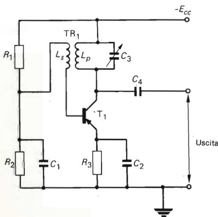
Fig. 7.15 - Oscillatore con accordo di collettore e alimentazione in serie.
