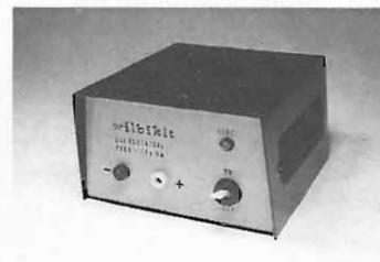
Alimentatore stabilizzato da 12 volt particolarmente idoneo per il funzionamento di radiotelefoni. Circuito a basso livello di ripple ed elevata stabilità anche nelle condizioni di massimo carico (2 ampère). Le dimensioni particolarmente ridotte consentono una facile sistemazione nel laboratorio o nella stazione radio. L'apparecchio è disponibile esclusivamente montato e collaudato.
