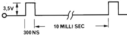
Fig. 4 - Regolazione della soglia del generatore di impulsi.
