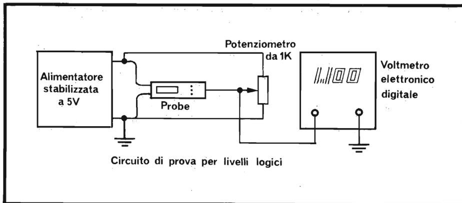
Fig. 2 - Sistema di collaudo del probe LPK-1.
