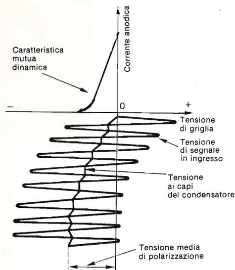
Fig. 7.12 - Comportamento iniziale di un circuito a polarizzazione automatica.
