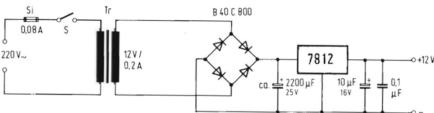
Figura 10 - Schema elettrico dell'alimentatore a rete dell'interfonico di figura 7.
