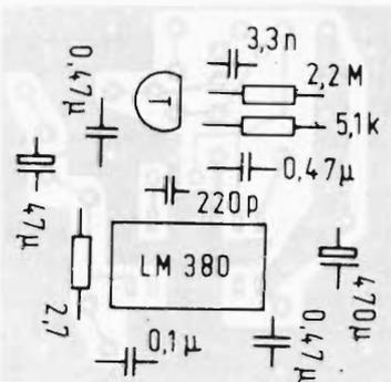
Figura 9 - Lato-parti del circuito stampato dell'interfonico di figura 7.
