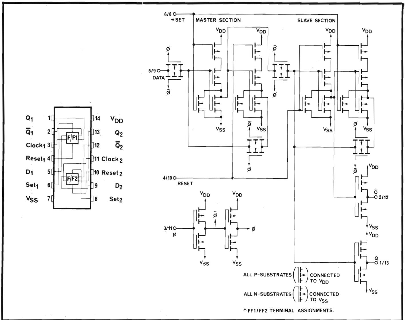
Fig. 6. - Connessioni e circuito logico equivalente dell'IC HBF 4013 (IC2).
