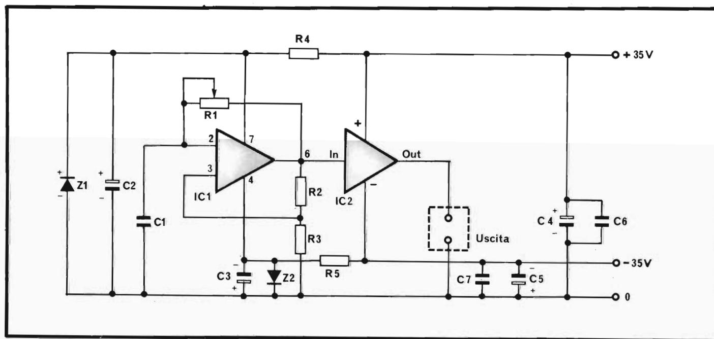
Fig. 1 - Schema elettrico del generatore di ultrasuoni
