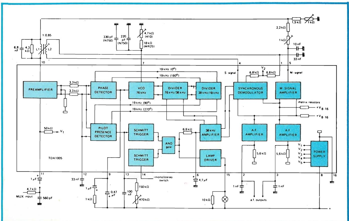
Fig. 1 - Schema a blocchi dell'integrato TOA 1005.
