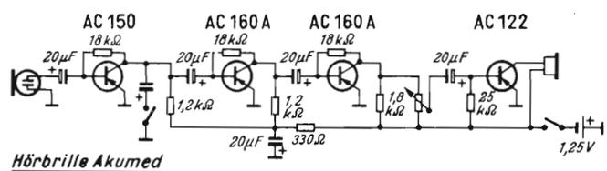
Figura 4 - Otonone Akumed "Hörbrille". L'interruttore che fa parte del primo stadio, se chiuso, incupisce il responso.
