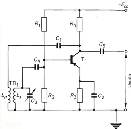
Fig. 7.17 - Oscillatore con accordo di base e alimentazione in parallelo.
