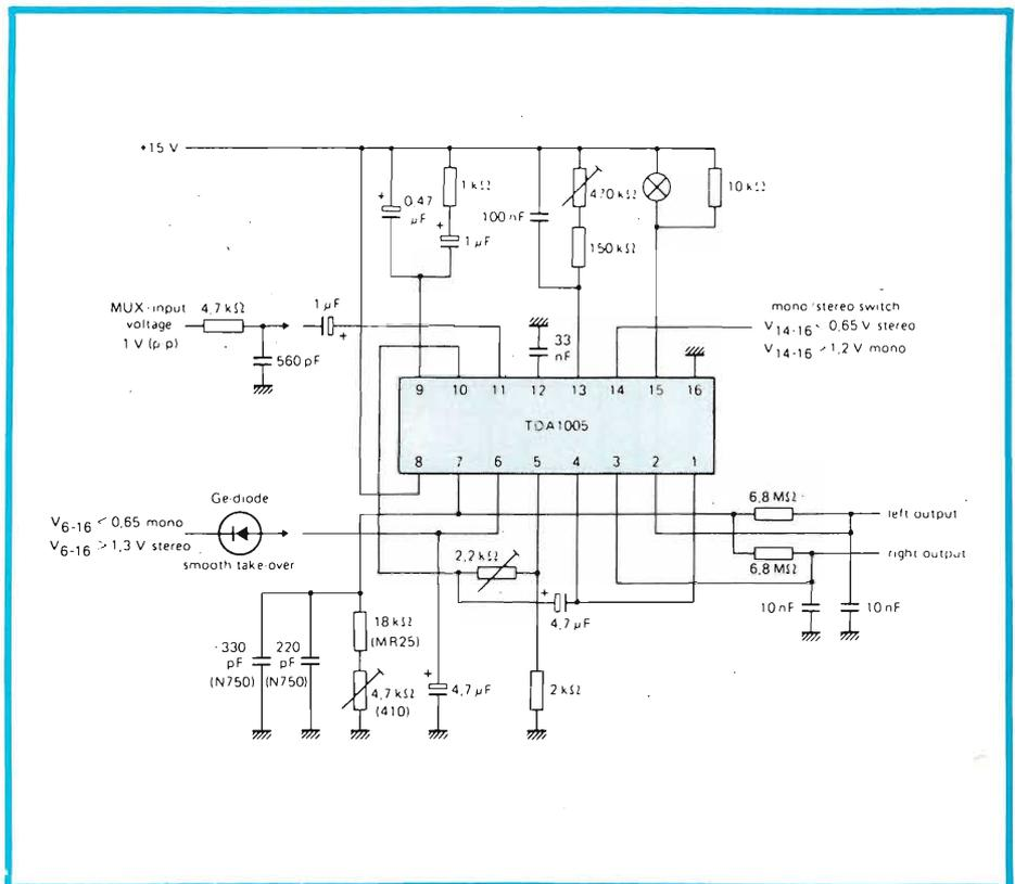
Fig. 3 - Altro circuito applicativo che provvede alla compensazione del coefficiente di temperatura.
