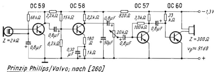
Figura 2 - Otonone Philips-Valvo "Prinzip". I transistori impiegati, al germanio, sono del tipo "subminiatura".
