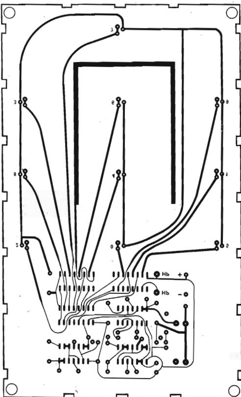
Fig. 4/A - La piastra rispecchia la faccia inferiore in scala 1 : 2.
