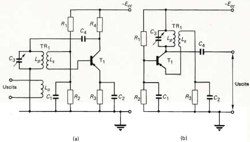
Fig. 7.16 - Oscillatori con accordo di collettore: a) con alimentazione in parallelo, b) con accoppiamento di emettitore.
