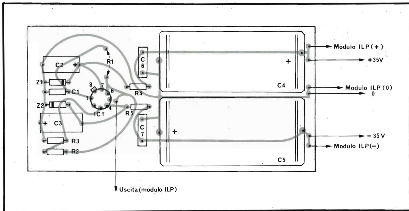
Fig. 2 - Disposizione dei componenti sulla basetta
