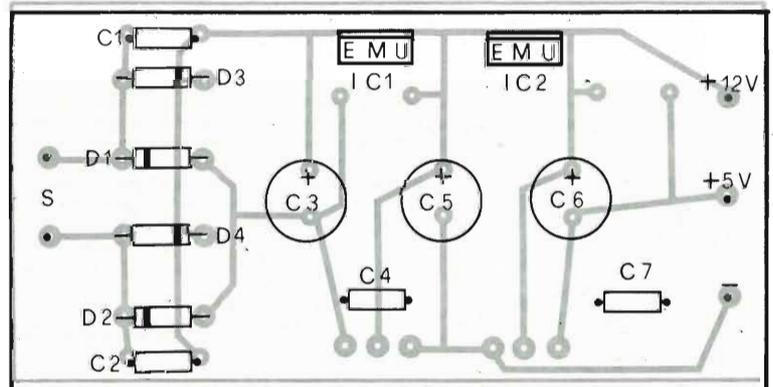
Fig. 8 - Basetta master vista dal lato componenti dell'alimentatore.
