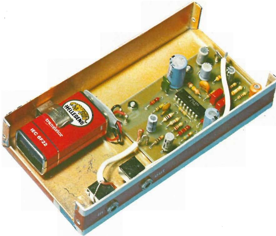
Vista interna del preamplificatore microfonico con A.L.C.
