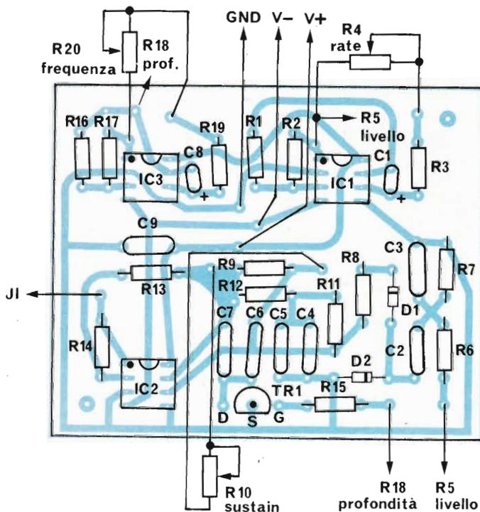
Fig. 2. - Disposizione dei componenti sulla basetta.
