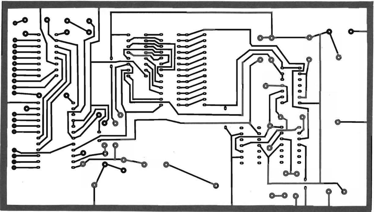
Fig. 3 - Basetta a circuito stampato della sintonia elettronica in scala 1:1.
