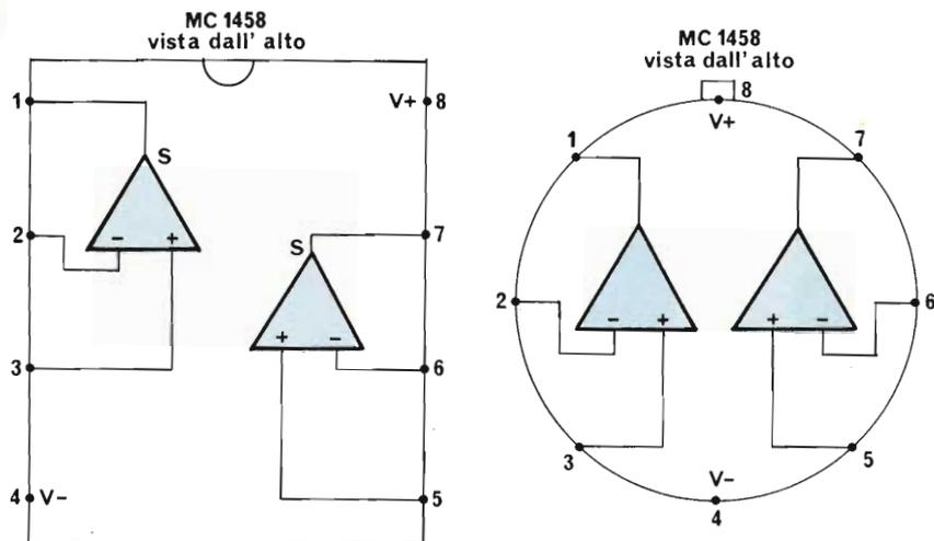
Fig. 3. - Zoccolatura dell'integrato MC 1458 usato in questo prototipo.
