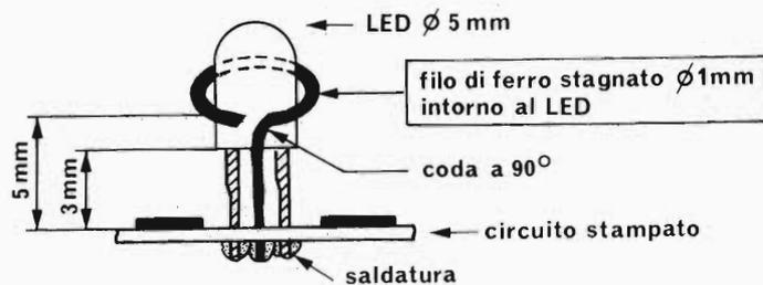
Fig. 6 - Dettagli di realizzazione di un terminale
