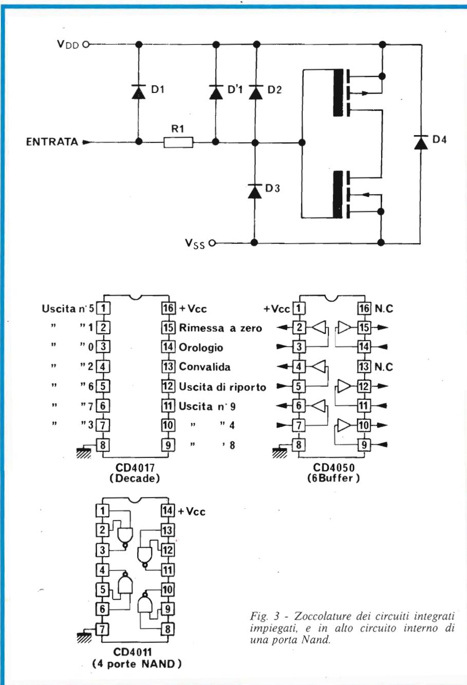
Fig. 3 - Zoccolature dei circuiti integrati impiegati, e in alto circuito interno di una porta Nand.
