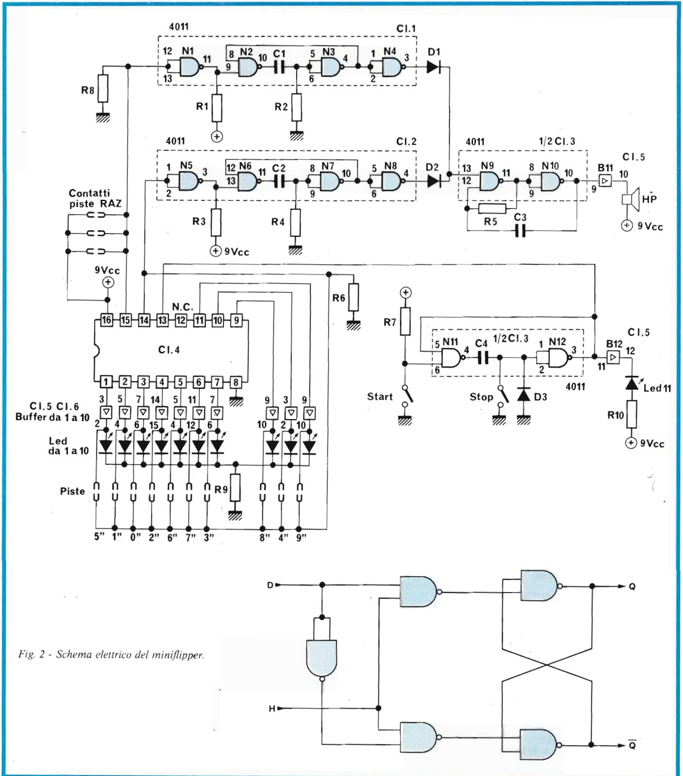
Fig. 2 - Schema elettrico del miniflipper.
