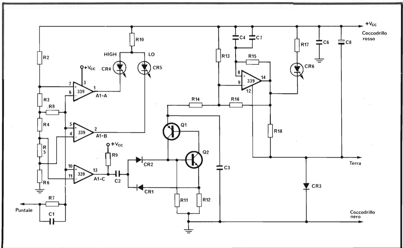
Fig. 1 - Schema elettrico del probe logico CSC LPK-1.
