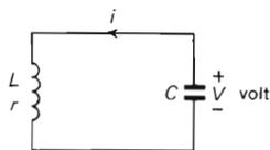
Fig. 7.6 - Il circuito oscillante, condizione iniziale.
