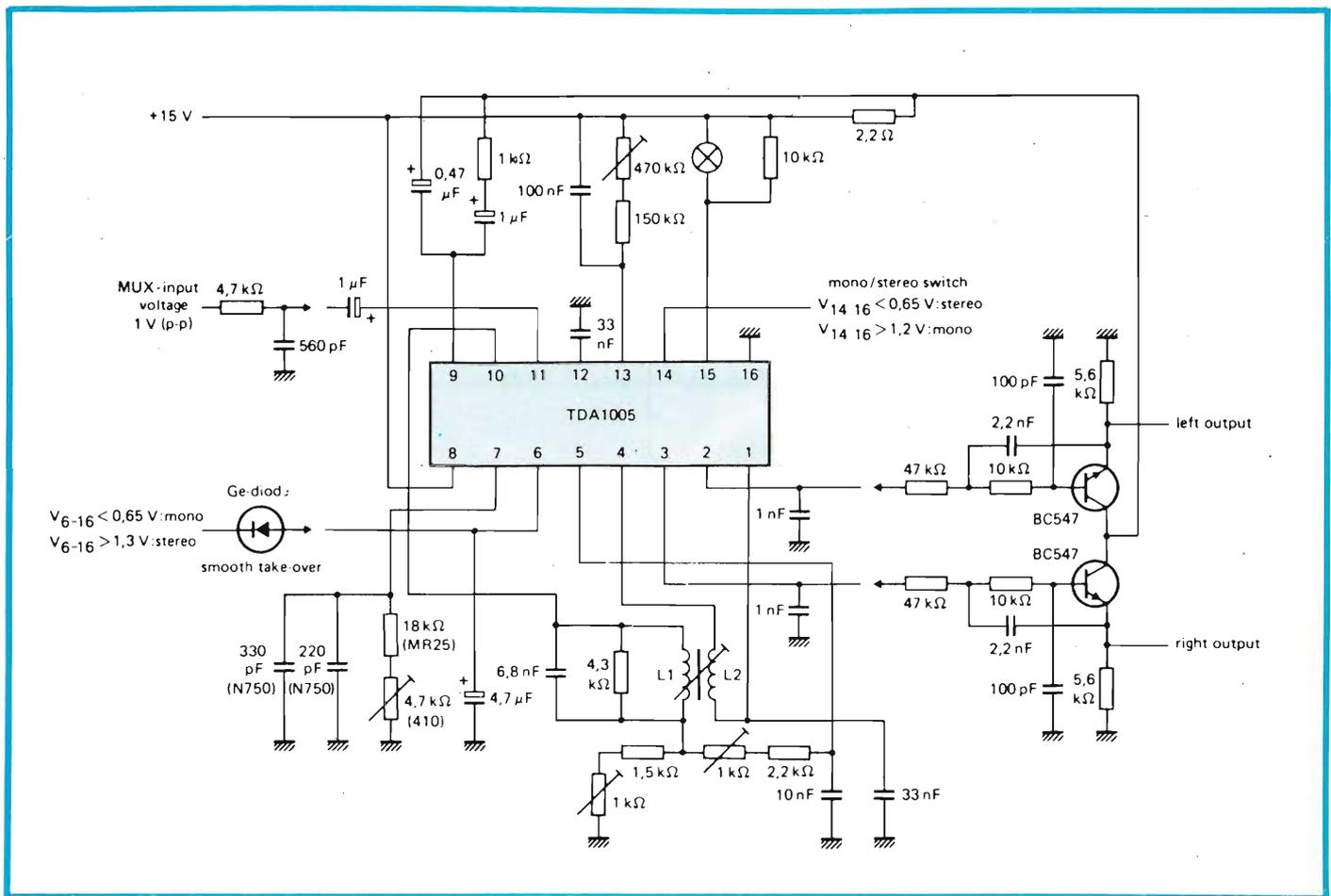
Fig. 2 - Circuito applicativo che provvede alla compensazione del coefficiente di temperatura.
