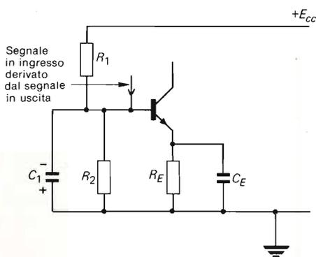
Fig. 7.13 - Polarizzazione automatica della base di un transistoro in un circuito oscillatore.
