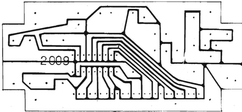
Figura 12 - Circuito stampato del contagiri di figura 11. Lato rame.
