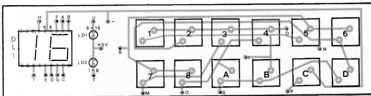
Fig. 5 - Circuito stampato lato componenti della tastiera e display.
