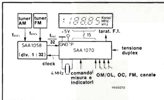
Schema a blocchi del sistema di misura di frequenza dei
