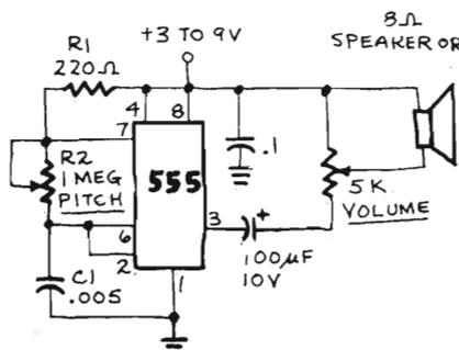
Figura 15 - Circuito di uno "scacciazanzare" elettronico ultrasonico.
