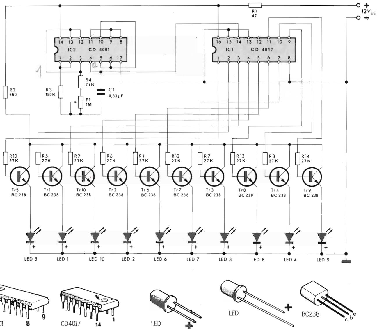
Fig. 1 - Schema elettrico del lampeggiatore sequenziale KS 261, e raffigurazione dei piedini dei semiconduttori impiegati.
