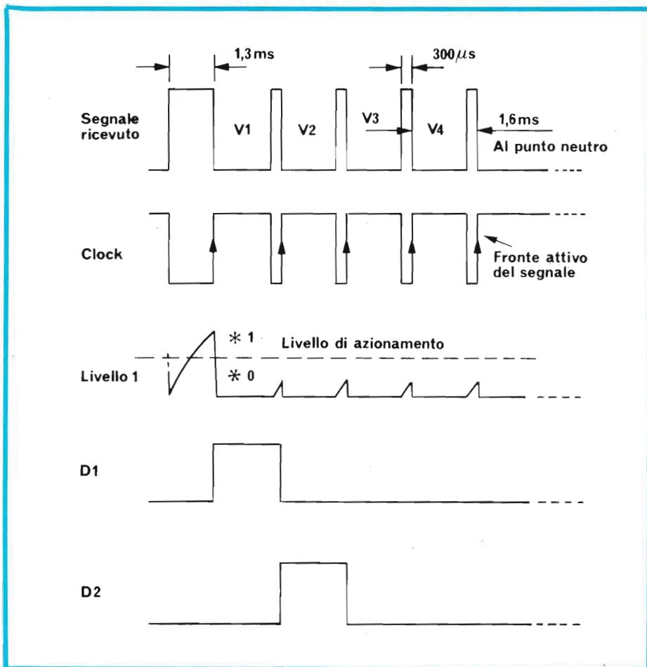
Fig. 1. - Come sono i segnali di modulazione inviati dal trasmettitore (in alto) e come si effettua la loro conversione per l'azionamento dei servocomandi (in successione verso il basso)
