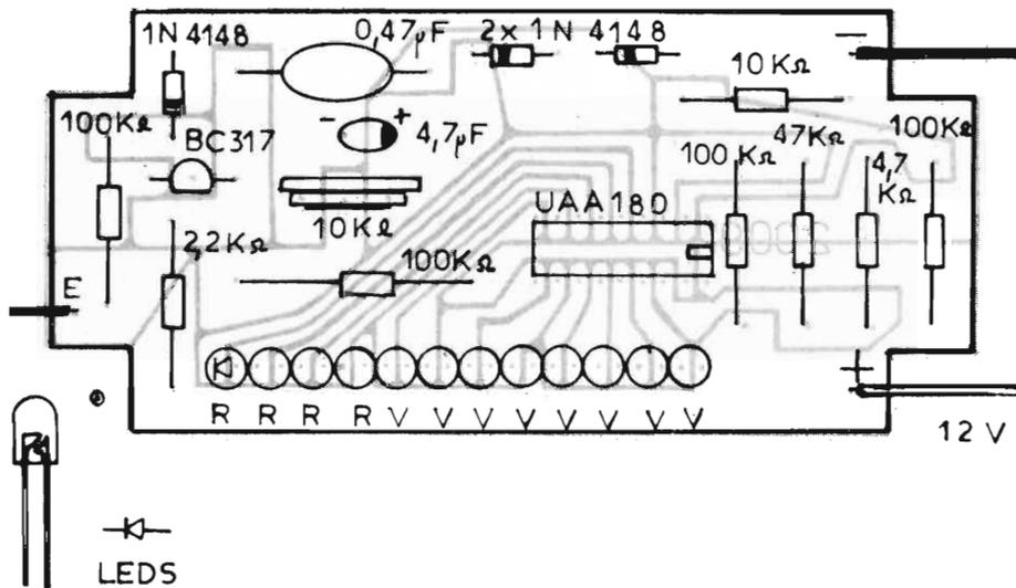
Figura 13 - Circuito stampato del contagiri di figura 11. Lato parti.
