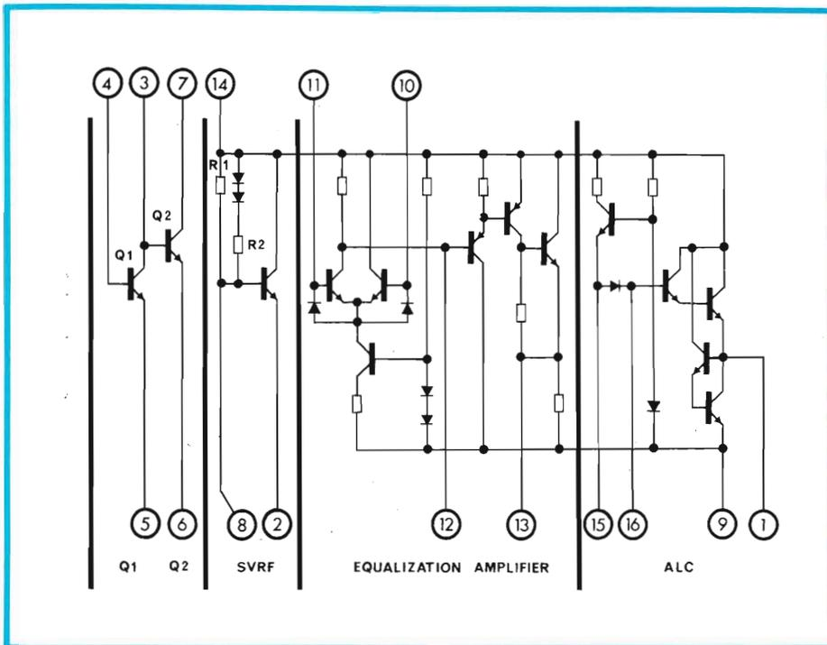
Fig. 1 - Circuito interno dell'integrato TDA 1054 usato nel preamplificatore.
